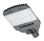
Las imágenes son sólo ilustrativas, el diseño, características y especificaciones del producto están sujetas a cambios sin previo aviso. Potencia 88,3 W Instalación Brazo pivotante Reemplazo 250 W vapor de sodio Flujo Luminoso 13,734 Lm
