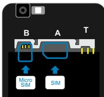
Para insertar una tarjeta SIM, respete la orientación como muestra la imagen dejando los contactos dorados hacia abajo. Como el dispositivo soporta doble SIM, es necesario colocar al menos una tarjeta en la ranura para su funcionamiento.
