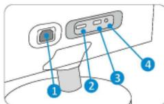
1. **Alimentación 220v:** Conector del cable de 220v.
